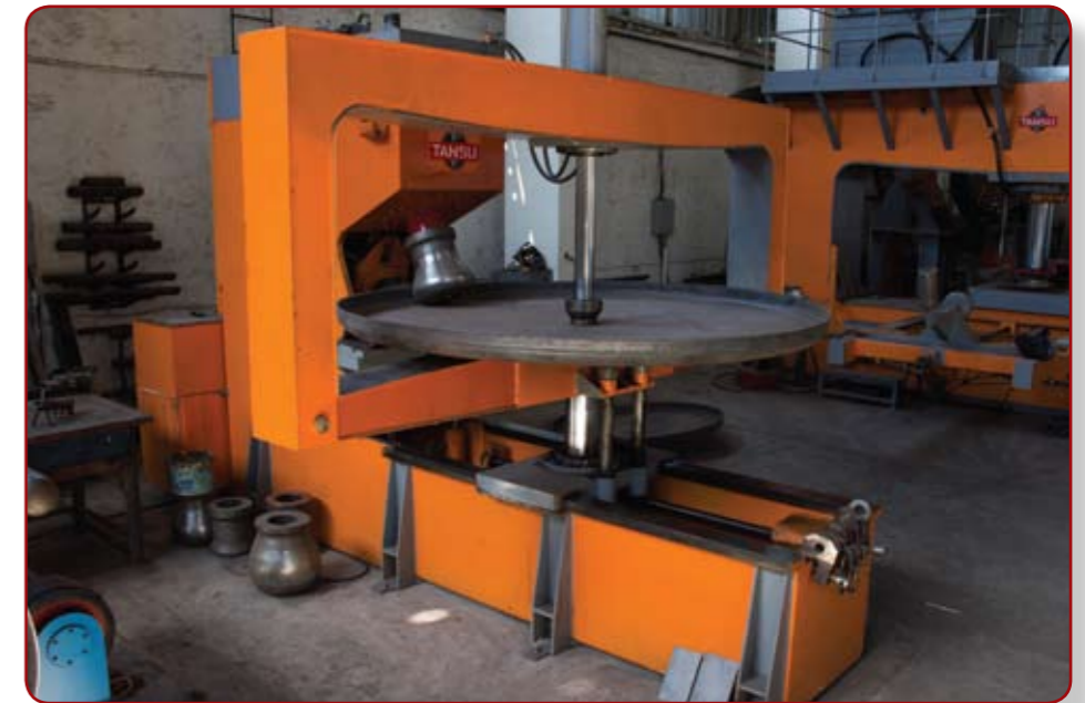
Фланжировочный (кромкогибочный) станок марки TANSU. Сделано в Кыргызстане.
