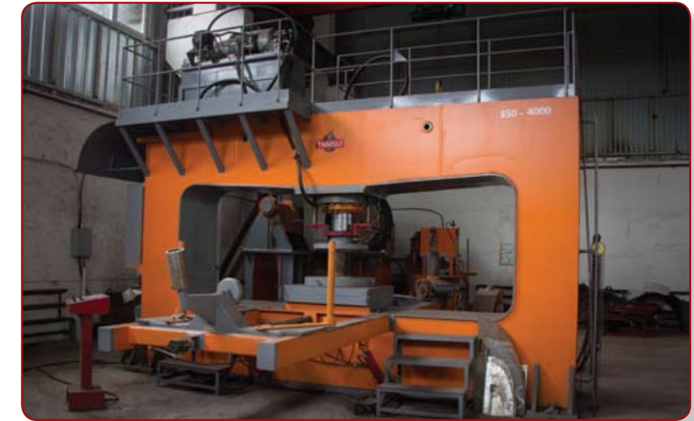
Гидравлический пресс для формовки эллиптических и других видов днищ марки TANSU. Сделано в Кыргызстане.
